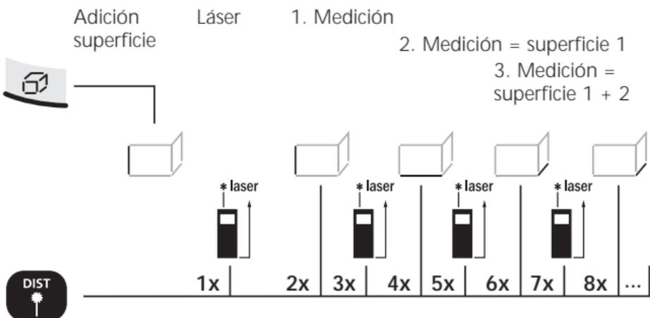
Adición otras superficies: láser encendido / ... medición = superficie 1 + superficie 2 + superficie 3 + ...
