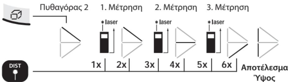
Η 2η μέτρηση γίνεται με την αυτόματη λειτουργία ελάχ./μέγ.
