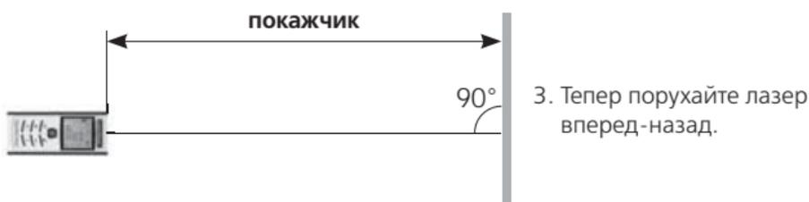
4. Швидке попискування: вимірне значення майже відповідає опорному  $\pm 1$  мм.
