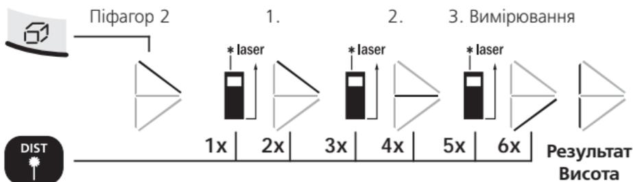
Друге вимірювання здійснюється автоматичною функцією «мін./макс.».
