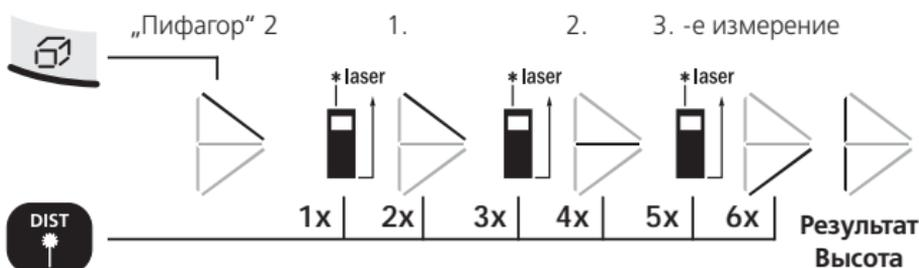
2-е измерение выполняется с помощью автоматической функции мин./макс.
