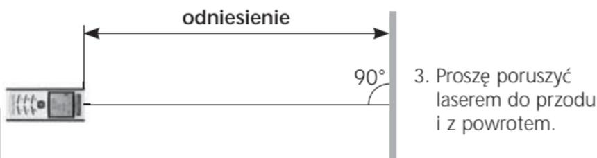
4. Szybki sygnał dźwiękowy: wartość pomiaru leży w zakresie wartości referencyjnej  $\pm 1$  mm.
