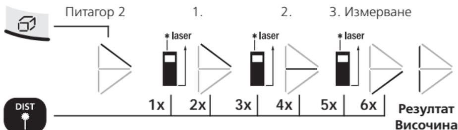
2-то измерване се извършва с автоматична функция мин/макс.
