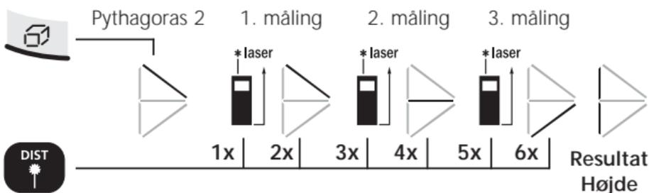
Den 2. måling sker med automatisk min/max-funktion.
