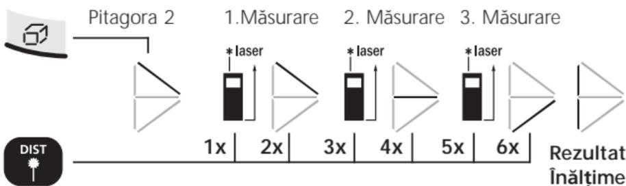
A 2-a măsurare se realizează cu funcția automată min/max.
