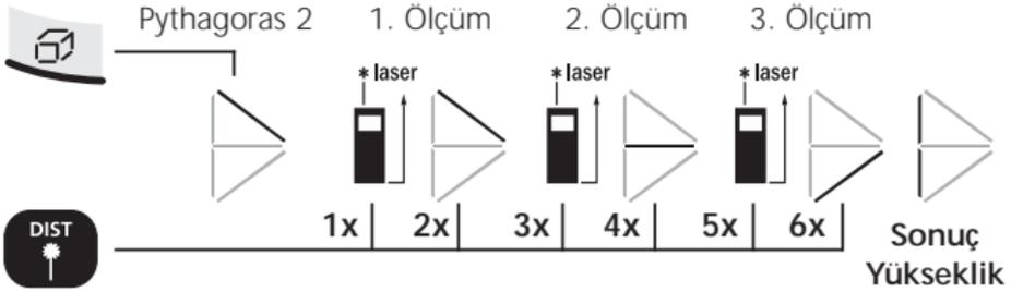
2. ölçüm otomatik min./maks. fonksiyonu ile gerçekleşir.
