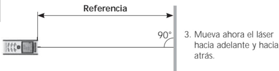
4. Pitido rápido: el valor medido se sitúa dentro del valor de referencia de  $\pm 1$  mm.
