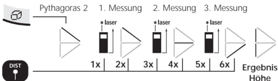
Die 2. Messung erfolgt mit automatischer min/max-Funktion.
