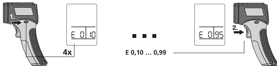
A cabeça sensora de medição integrada recebe a radiação infravermelha que cada corpo emite conforme o material/a superfície. O grau da radiação é determinado pelo grau de emissão (0,10 até 0,99). O aparelho tem um pré-ajuste no grau de emissão de 0,95, que é o valor indicado para a maior parte das substâncias orgânicas, como plásticos, cerâmica, madeira, borracha e rochas. Os materiais com graus de emissão diferentes podem ser consultados na tabela da página seguinte no ponto 11.
