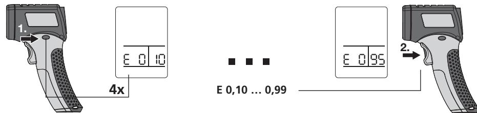
Mittauspäähän integroitu anturi ottaa vastaan infrapunasäteilyä, jota kaikki esineet lähettävät materiaalille/pintamateriaalille ominaisella tavalla. Emissioarvo (0,10 - 0,99) määrittelee säteilyn asteen. Oletusasetuksena laitteen emissioarvoksi on asetettu 0,95. Se sopii useimille orgaanisille aineille sekä muoville, keramiikalle, puulle, kumille ja kivelle. Katso emissioarvoltaan poikkeavat materiaalit seuraavalla sivulla kohdassa 11 olevasta taulukosta.
