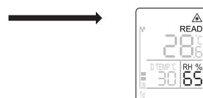
Durante el proceso de medición se calcula y muestra automáticamente la humedad relativa del aire.
