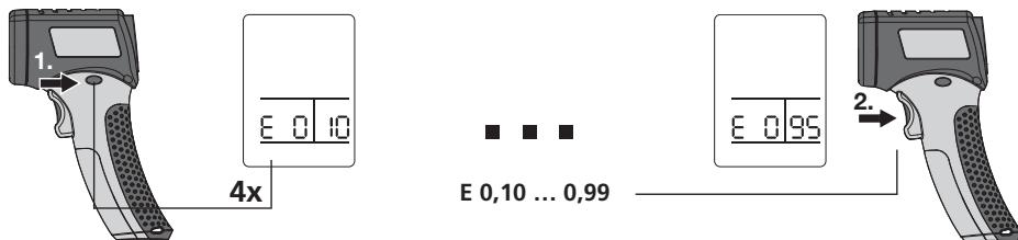
De geïntegreerde sensormeetkop ontvangt de infraroodstraling die ieder lichaam materiaal-/oppervlakteafhankelijk uitstraalt. De graad van de uitstraling wordt bepaald door de emissiegraad (0,10 t/m 0,99). Het apparaat is voor ingesteld op een emissiegraad van 0,95 hetgeen van toepassing is voor de meeste organische stoffen zoals kunststof, keramiek, hout, rubber en gesteente. Voor materialen met afwijkende emissiegraden verwijzen wij naar de tabel onder punt 11 op de volgende pagina.
