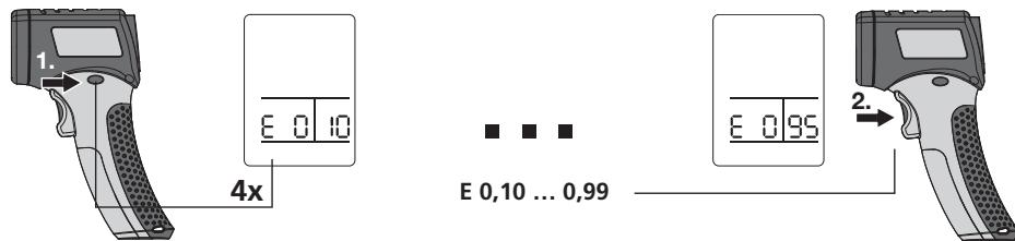
Det integrerade sensormäthuvudet tar emot den infraröda strålningen som alla föremål avger material-/ytspecifikt. Graden av strålning bestäms av emissionsgraden (0,10 till 0,99). Mätinstrumentet är fast inställt på en emissionsgrad på 0,95, vilket stämmer för de flesta organiska material, såsom plaster, trä och gummi samt keramik och sten. Material med avvikande emissionsgrad framgår av tabellen på nästa sida under punkt 11.
