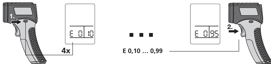
Der integrierte Sensormesskopf empfängt die Infrarot-Strahlung, die jeder Körper material-/oberflächenspezifisch abgibt. Der Grad der Abstrahlung wird durch den Emissionsgrad bestimmt (0,10 bis 0,99). Das Gerät ist auf einen Emissionsgrad von 0,95 voreingestellt, was für die meisten organischen Stoffe, sowie Kunststoffe, Keramik, Holz, Gummi und Gestein zutreffend ist. Materialien mit abweichenden Emissionsgraden entnehmen Sie der nachfolgenden Tabelle unter Punkt 11.
