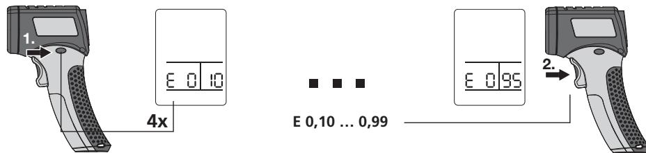
Вградената сензорна измервателна глава приема инфрачервено лъчение, което всяко тяло излъчва специфично за материала и повърхността си. Степента на това излъчване се оценява чрез коефициента на излъчване (0,10 до 0,99). В прибора е зададен предварително коефициент на излъчване 0,95, който е подходящ за основните органични материали, като пластмаса, керамика, дърво, гума и камък. Материали с отклоняващи се коефициенти на излъчване може да видите в таблицата на следващата страница под точка 11.
