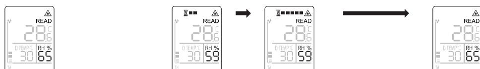
Η σχετική υγρασία αέρα μετράται και εμφανίζεται αυτομάτως κατά τη διαδικασία μέτρησης.
