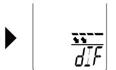
4. Diferença de temperatura por infravermelhos (Máx. / Min.)
