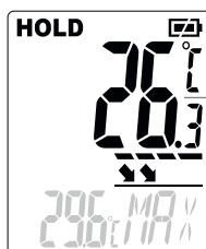
Відображення температури за інтенсивністю теплового випромінювання (для кожного режиму вимірювання)
