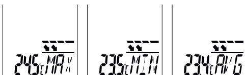
Режимы Max/Min/Avg относятся к измерению температуры в инфракрасной области спектра и выводят на экран, соответственно, максимальную, минимальную или среднюю температуру, определенные этим способом. Значения Max/Min/Avg определяются во время текущего измерения при нажатой кнопке пуска (9). При запуске нового измерения или в результате нажатия кнопки пуска (9) значение удаляется и вычисляется заново.
