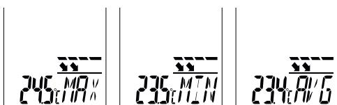
Režimy Max/Min/AVG se vztahují na infračervené měření teploty a ukazují vždy maximální, minimální nebo průměrnou teplotu zjištěnou infračerveným měřením. Hodnoty Max/Min/AVG se stanovují během probíhajícího měření při stisknuté spoušti (9). Při spuštění nového měření nebo stisknutím spouště (9) se hodnota vymaže a vypočítá znova.
