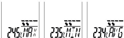
Режими Max/Min/Avg відносяться до вимірювання температури за інтенсивністю теплового випромінювання та відображають відповідно максимальну, мінімальну та середню температуру. Показники Max/Min/Avg визначаються під час поточного вимірювання – для цього спускова кнопка (9) має бути натиснута. З початком нового вимірювання або після натискання спускової кнопки (9) показник буде видалено та розраховано повторно.
