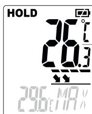
Infrapunalämpötilamittauksen näyttö (kaikissa käyttötiloissa)
