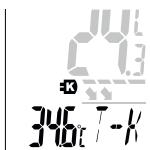
Laite kytkeytyy automaattisesti käyttötilaan Kosketuksellinen lämpötilanmittaus T-K, kun (K-tyyppin) lämpötila-anturi liitetään laitteeseen. Lämpötila-anturin ollessa liitetynä, laite ei kytkeydy automaattisesti pois päältä, jos paristojen varauusta on vähintään 15%.
