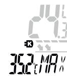
! Min.-/maks-verdiene slettes når det skiftes modus, samt når instrumentet slås på/av.
