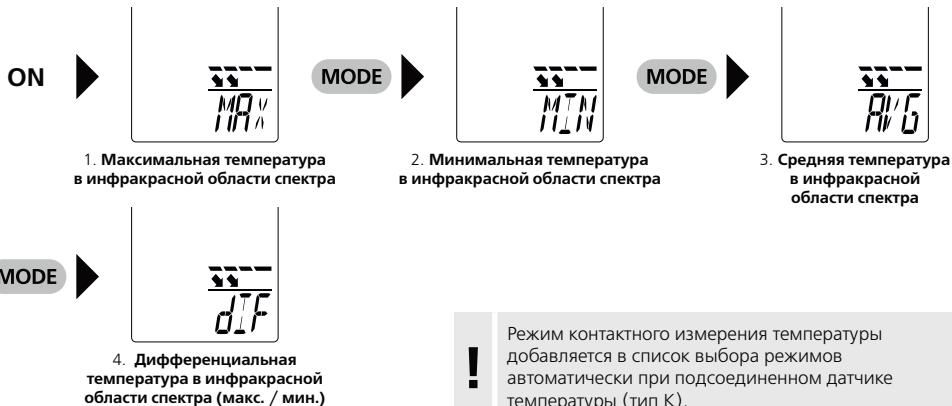
! Режим контактного измерения температуры добавляется в список выбора режимов автоматически при подсоединении датчика температуры (типа K).
