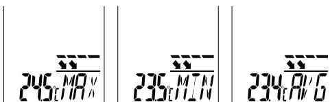
Lägerna Max/Min/Avg refererar till infraröd-temperatur och visar maximal, minimal eller genomsnittlig infraröd-temperatur. Värdena Max/Min/Avg meddelas under löpande mätning när man trycker på utlösaren (9). När man startar en ny mätning resp. trycker på utlösaren (9) raderas värdet och beräknas på nytt.
