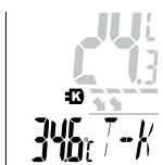
Bir sıcaklık sensörü (K tipi) bağlılığında, cihaz otomatik olarak T-K temas sıcaklık moduna geçer. Sıcaklık sensörü bağlı durumdayken cihazın batarya şarjı en az %15 ise cihaz otomatik olarak kapanmaz.
