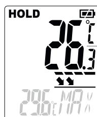
Показания температуры, измеренной в инфракрасной области спектра (в любом режиме измерений)
